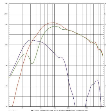
Rys. 3 Charakterystyki źródeł niskich częstotliwości (poniżej 1 kHz, pomiar w polu bliskim).
